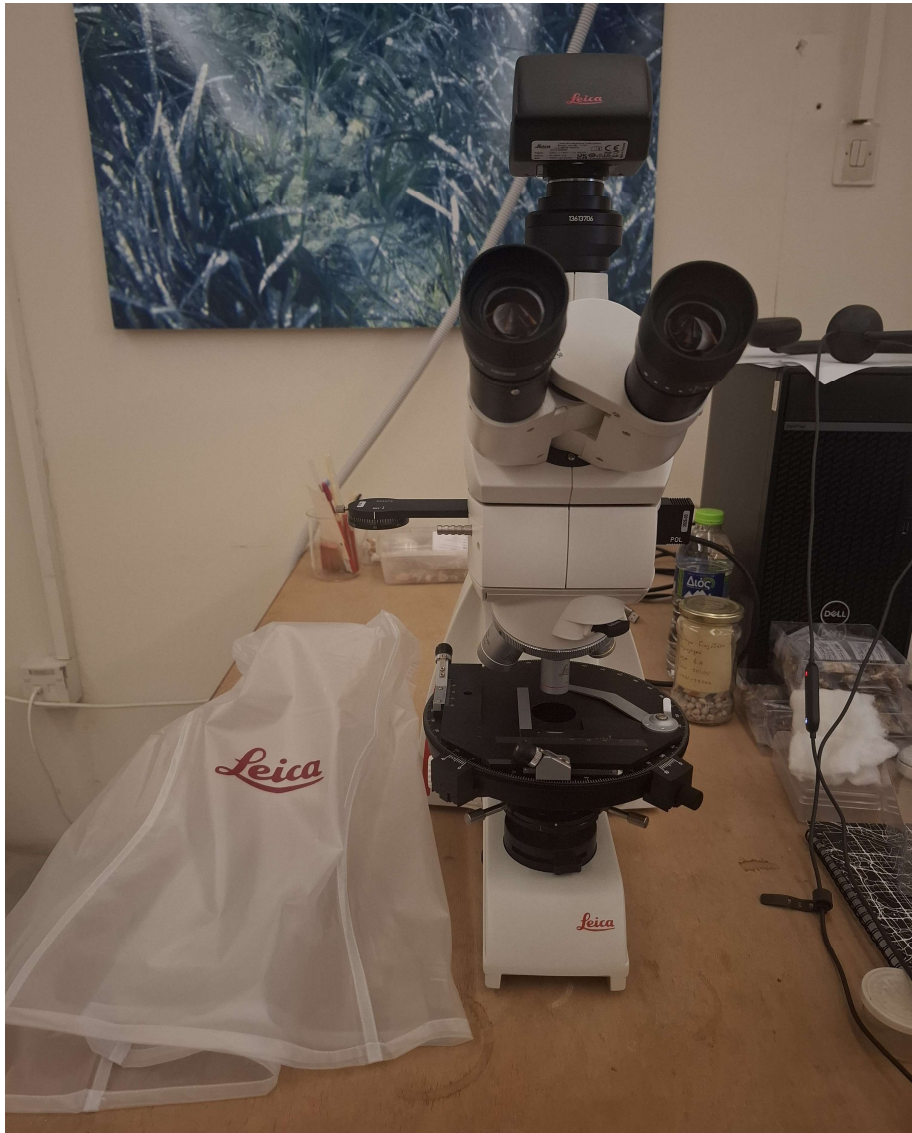
Εικόνα 6 / Πολωτικό μικροσκόπιο DM750P εργαστηρίου που χρησιμοποιείται για την αναγνώριση φάσεων και την ανάλυση κρυσταλλικής δομής.
