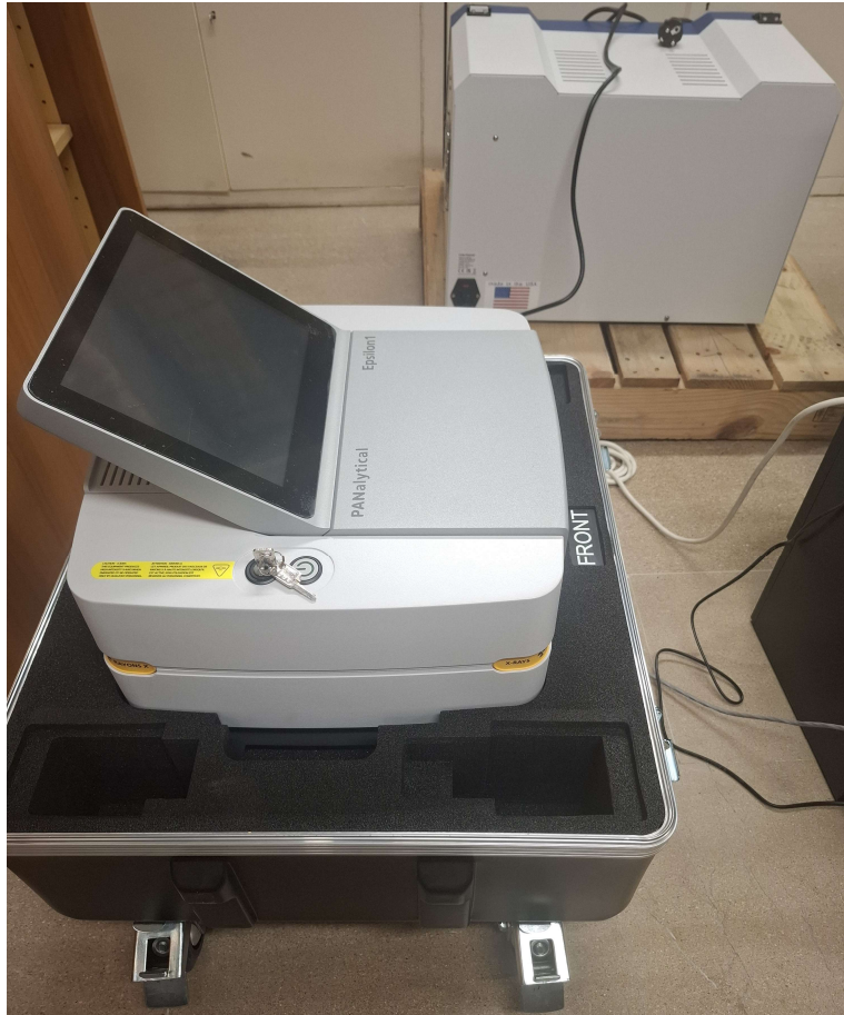
Εικόνα 4 / Όργανο XRF και εργαστηριακός μύλος για την άλεση και ομογενοποίηση των δειγμάτων πριν τη φασματοσκοπική ανάλυση
