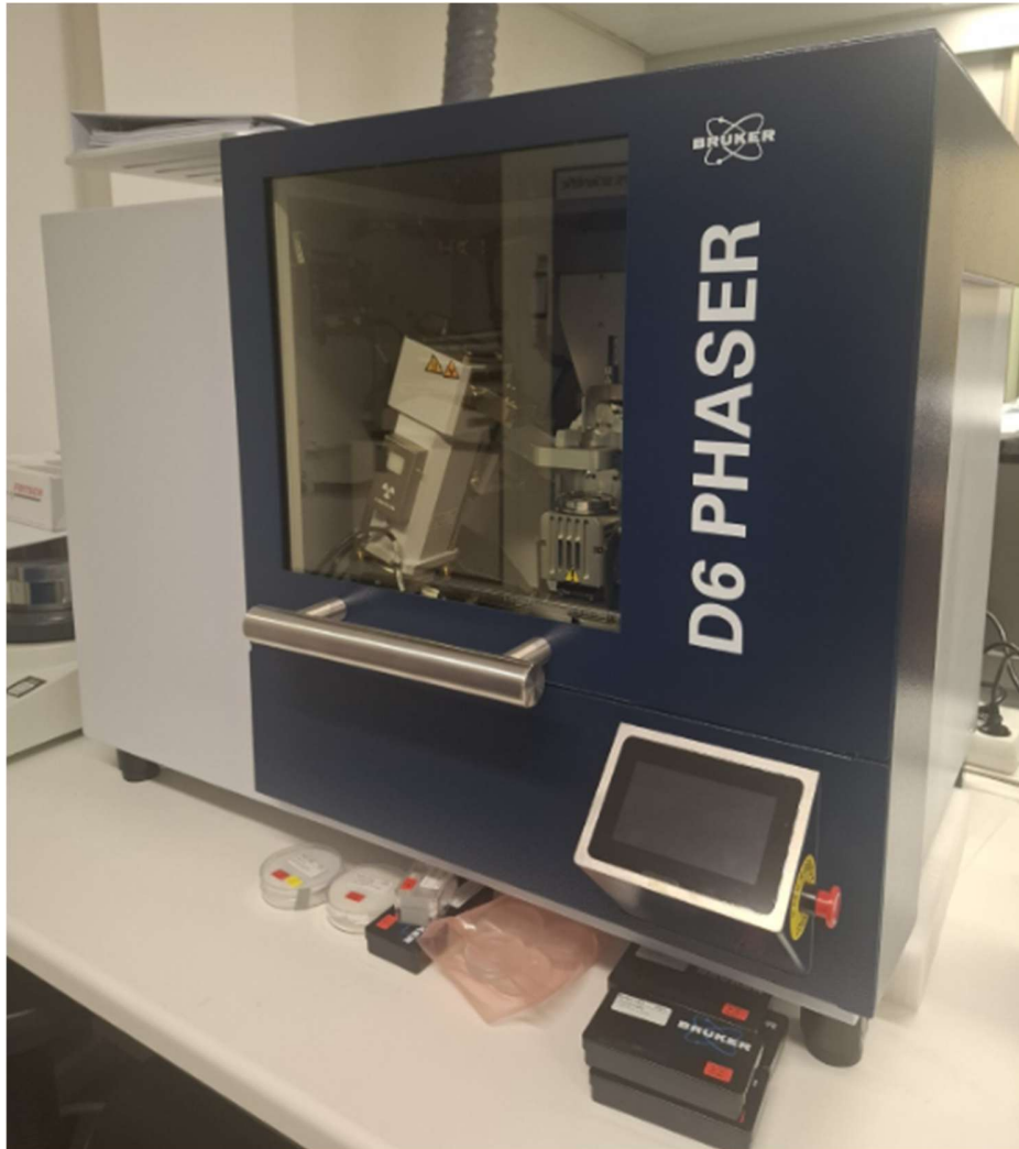
Εικόνα 1 / Εξοπλισμός περίθλασης ακτίνων X (XRD) που χρησιμοποιείται για την ανάλυση της κρυσταλλικής δομής υλικών
