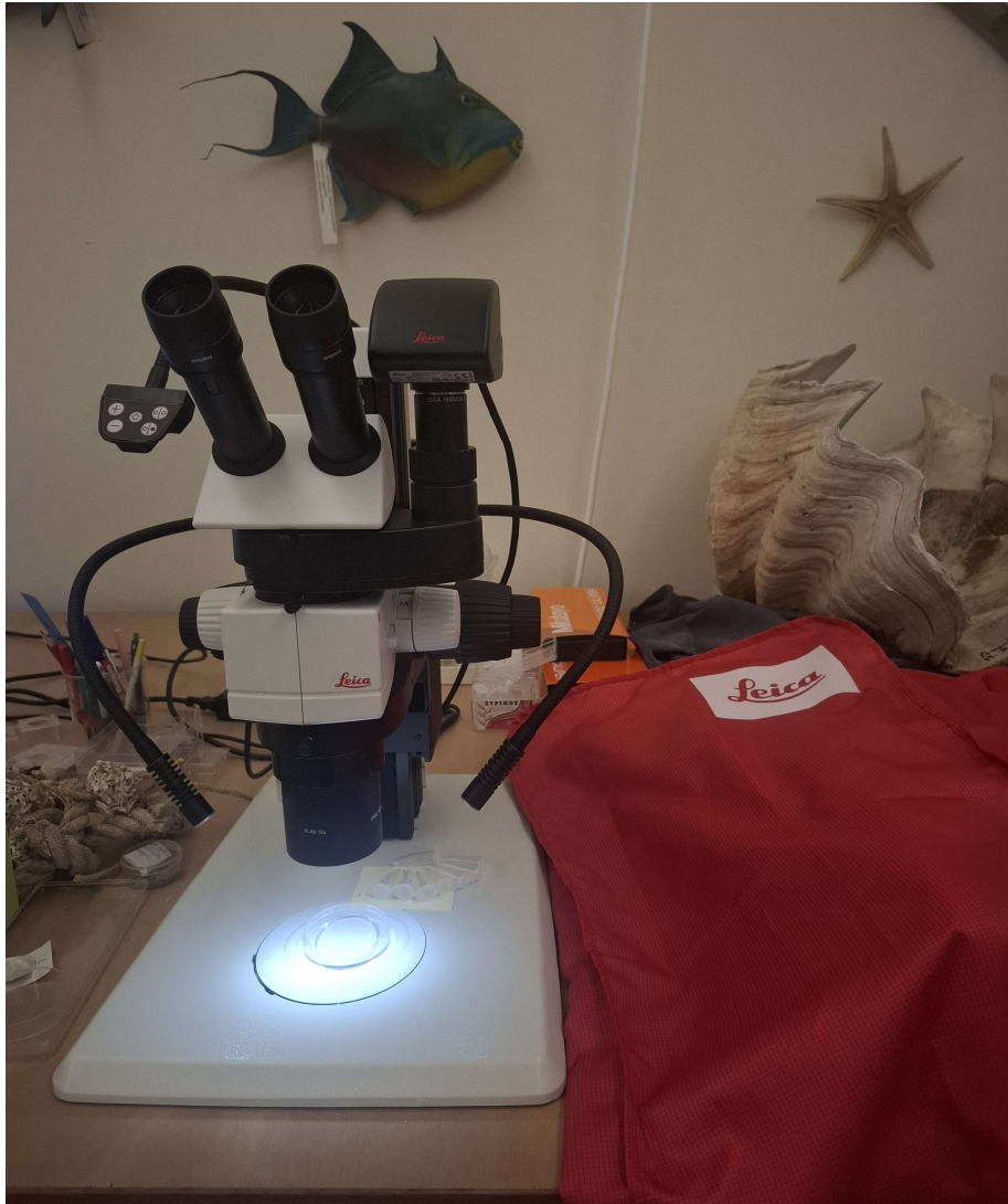
Εικόνα 5 / Στερεοσκόπιο LEICA M80 για την τρισδιάστατη παρατήρηση και μικροσκοπική εξέταση δειγμάτων.
