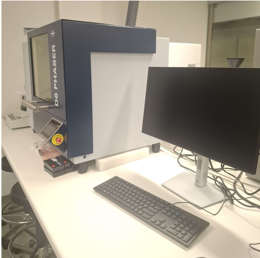
Εικόνα 2 / Σύστημα XRD σε συνδυασμό με Η/Υ για τη συλλογή, επεξεργασία και ανάλυση των φασμάτων περίθλασης
